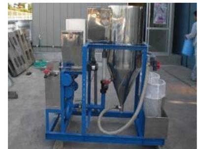
図表 7 : 濁水処理装置
